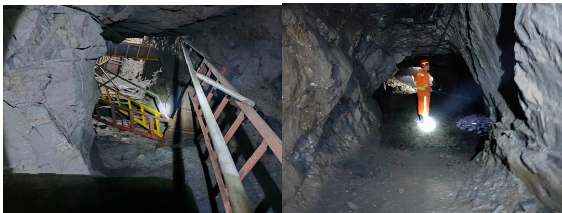
+150m中段采场西侧采准天井、联络道、拉低巷道
